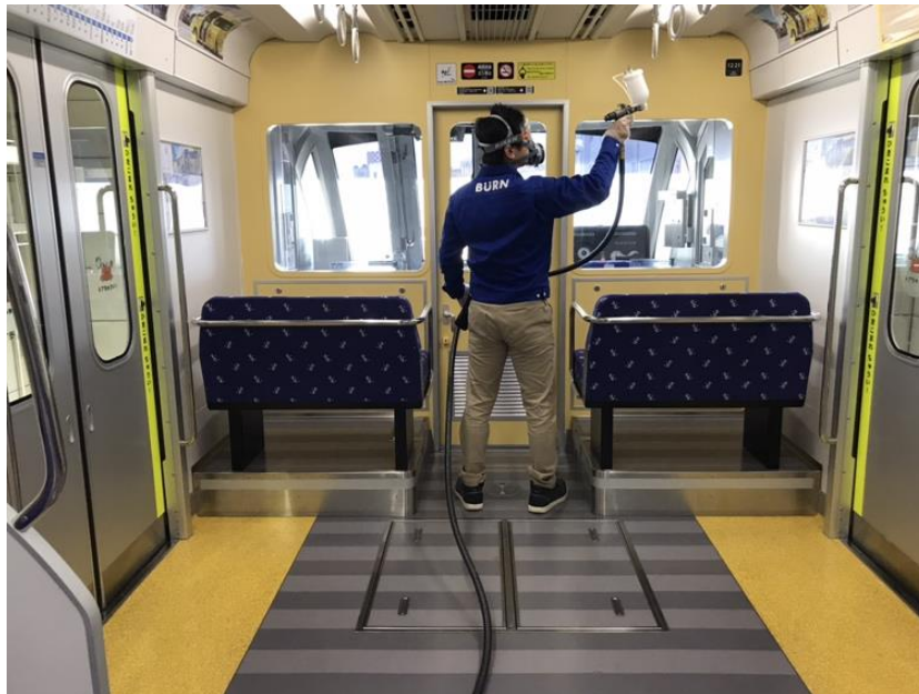
抗ウイルス抗菌コーティング（「レコナ エアフレッシュ」） ゆいレール車両内の作業の様子
